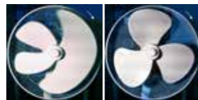
Rolling / Global Shutter Aufnahme eines rotierenden Ventilators mit unterschiedlicher Verschluss technik.
