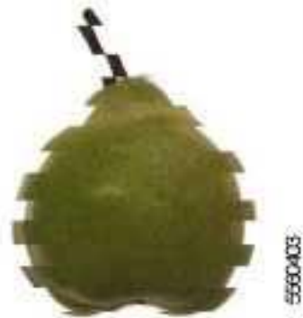
Bild 35: Kammefekt bei bewegten Objekten im Vollbild-Modus (schematisch)
